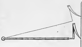
Fig. 98. — Pointe élastique traçant sur une glace enfumée.
